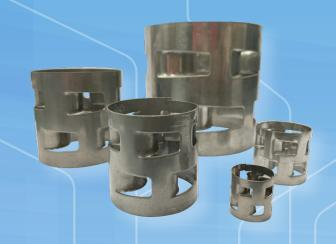
與塑料鮑爾環相比,這種鮑爾環填料具有更高的機械強度和更好的傳質性能。適用於易分解,聚集或碳化的材料。金屬鮑爾環具有良好的操作靈活性和大的生產能力。它 適用於各種分離和吸收應用,如氣體脫水,甲烷和二氧化碳的去除。金屬鮑爾環具有多種材料。它可以由各種不銹鋼製成。
